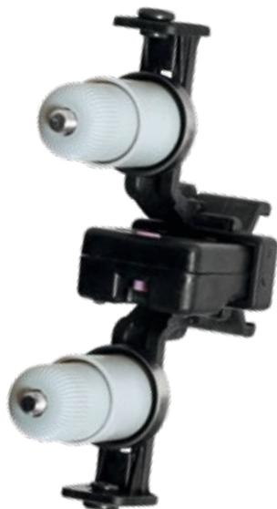
iSpy implementa all'interno dello stesso dispositivo una doppia tecnologia. All'originale principio di riconoscimento del movimento del filo basato sulla rilevazione delle cariche elettrostatiche, si è aggiunta una cella ottica che permette di individuare le vibrazioni che i filati presentano in corrispondenza del loro movimento.
